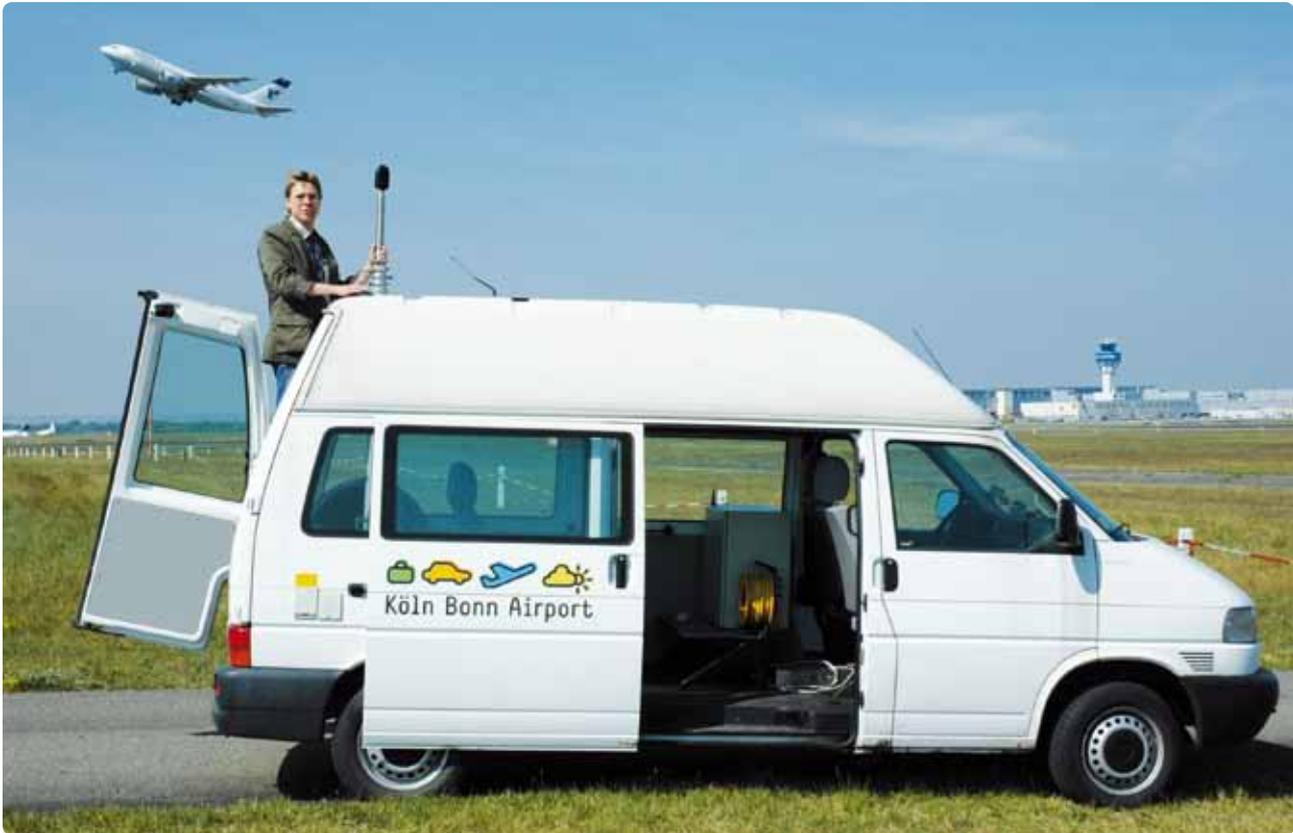
Mit einem Messwagen, zwei mobilen und vierzehn festen Messstellen misst der Airport präzise den Fluglärm.
