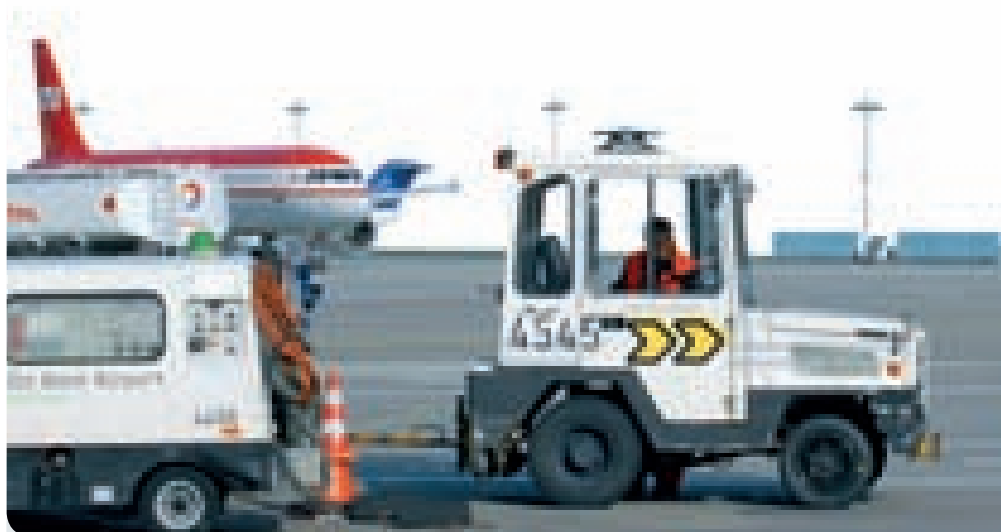
Die modernen Ground Power Units verbrauchen deutlich weniger Kraftstoff.
