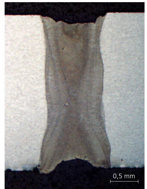
Oben: Oberraupe und Wurzel, Stumpfstoß AlMg3, 3 mm, P_1 = 4 \text{ kW} , v_s = 3 \text{ m/min} , Doppelfokus mit Wurzelschutz Ar. Unten: Querschliff.
