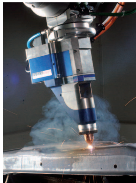
Oben: Bearbeitung einer B-Säule mit dem Kombikopf beim Schneiden ... Unten: ... und beim Schweißen.
