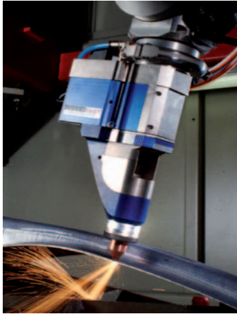
Kombibearbeitung von Automobilkomponenten aus hochfestem Stahl.
