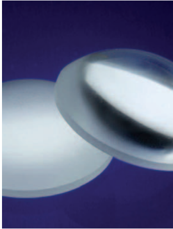
Polieren von Glas- und Kunststoffoptiken mit Laserstrahlung. Laserpolierte und unpolierte BK7-Linse.
