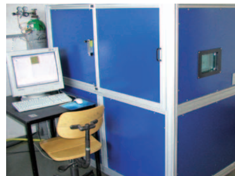
Oben: Demonstrator für die ortsauflöste Mikroanalyse mit Laser, Simultanspektrometer und Probenkammer sowie Signal- und Steuerelektronik. Mitte: Probenträger für die gleichzeitige Aufnahme von bis zu 4 Stahlproben mit Durchmessern bis zu 40 mm, z. B. Referenzproben für die Kalibrierung. Unten: Probenträger für Rechteckproben mit Abmessungen bis 70 x 70 mm 2 .
