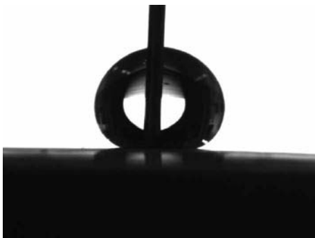
Oben: Mikrostrukturiertes Werkzeug mit Näpfchenstruktur. Mitte: Abformung des Werkzeugs in PDMS. Die Abformung erhält eine Säulenstruktur. Unten: Kontaktwinkelmessung der PDMS-Abformung mit Säulenstruktur.
