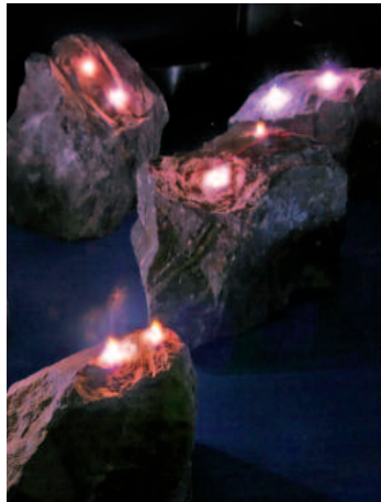
Laserinduzierte Plasmen auf Gesteinsproben bei der Einzelkornanalyse zur Mineralientrennung.
