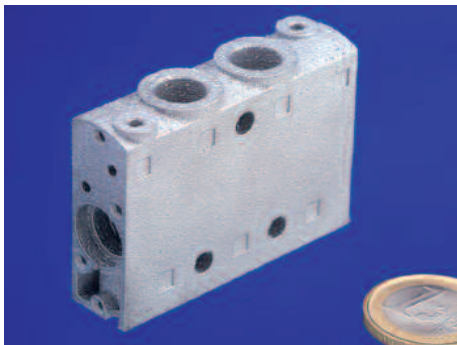
Oben: Zugfestigkeit R_m von SLM Proben aus AlSi10Mg in Abhängigkeit von Scangeschwindigkeit, Aufbauorientierung und Vorwärmtemperatur. Mitte und unten: Mit SLM gefertigtes Großserien-Ventil aus AlSi10Mg (in Kooperation mit Festo AG & Co. KG).
