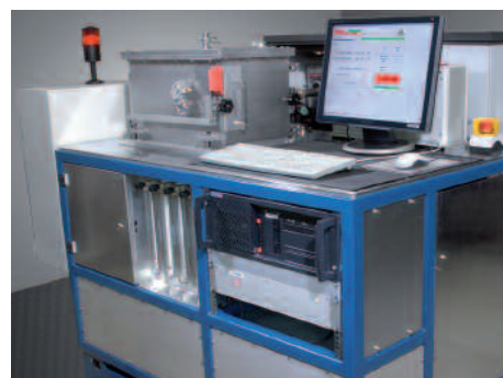
Oben: Blick durch das Beobachtungsfenster in die Messkammer. Auf der Probenoberfläche wird ein laserinduziertes Plasma gezündet, dessen Emission über einen Direktlichtkanal in ein Spektrometer geführt wird. Unten: ILCOM-Demonstrator.
