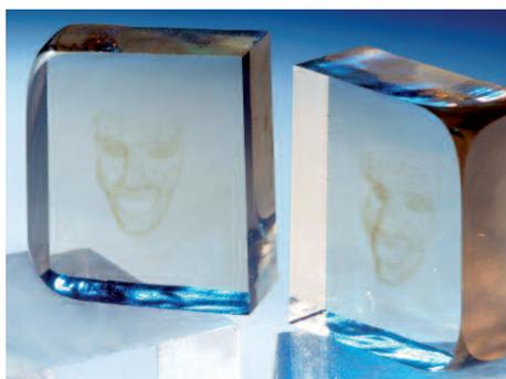
**Oben:** Violette Farbmarkierung in Kalk-Natron-Silicatglas ( $3 \times 3 \times 1 \text{ cm}^3$ ) mit  $\text{V}_2\text{O}_5$ - und  $\text{Ce}_2\text{O}_3$ -Dotierungen durch lineare Absorption von ns-UV-Laserstrahlung eingebracht.
