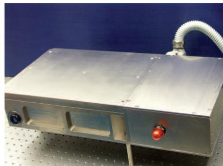
Industrienaher Prototyp eines Nd:YVO<sub>4</sub>-Oszillators.
