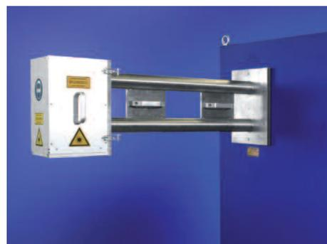
**Oben:** ScanLis mit montiertem Probenstandmodul.
