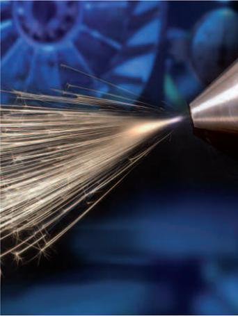
Entwicklung von Beschichtungsköpfen zum Laserstrahl-Auftragschweißen.
