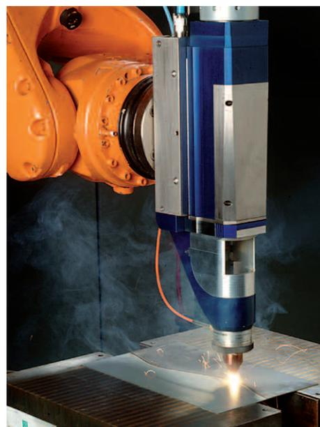
Zuschneiden der Fügekanten und Verschweißen in unmittelbarer Folge.
