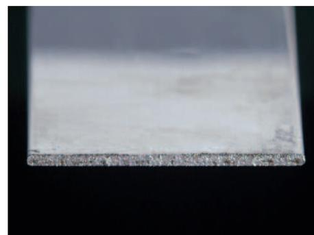
**Oben:** Remote-Schneiden von Stahlwerkstoffen.
