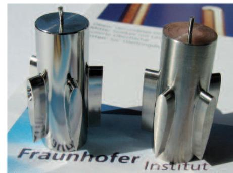
**Oben:** Implantate aus Titan, rechts: Ausgangszustand, links: poliert mit Laserstrahlung.
