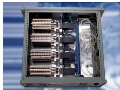
Oben: On/Off-Verstärkung im C-Band für Signale mit -3 dBm Leistung.
