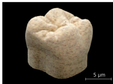
**Oben:** Mit dem Selektiven Laserschmelzen hergestelltes Demonstrationsbauteil aus  $ZrO_2$ -basierter Keramik.
