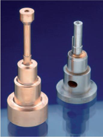
Formkerne eines Spritzgießwerkzeuges. Links: Rohling, rechts: fertig bearbeitetes Teil.
