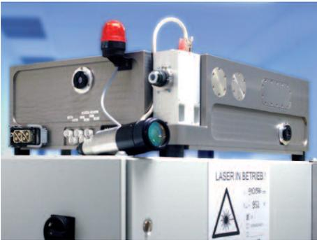
**Oben:** 1kW-Diodenlaser mit Faserkopplung (Faserdurchmesser 600 µm, Gehäuseabmessungen 700 x 550 x 220 mm<sup>3</sup>) und Bearbeitungsoptik (Abbildungsmaßstab 4:1).
