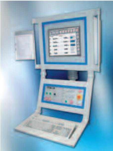
OSACA-Steuerung für eine Laseranlage.
