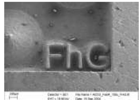
**Oben:** Mikrostrukturierung von  $\text{Al}_2\text{O}_3$  Grünkeramik.
