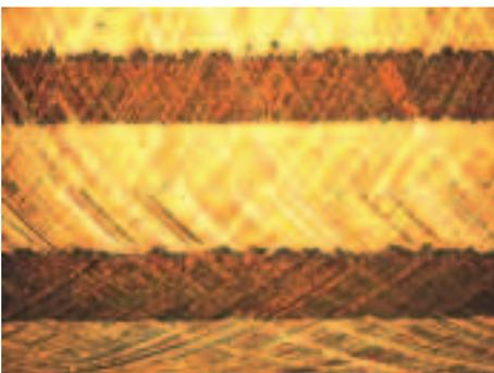
**Oben:** Ausdehnungsangepasste Mikrokanal-Wärmesenke.
