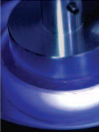
Messung einer Glas-Referenzprobe auf dem Probenstisch des Spektrometers.
