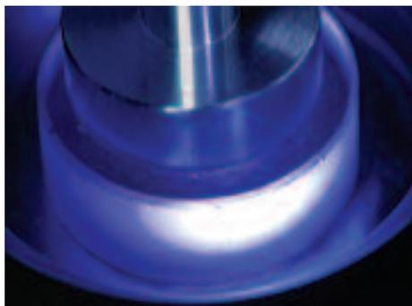
Messung einer Glas-Referenzprobe auf dem Proben Tisch des Spektrometers. Die Laserbestrahlung erfolgt von der Unterseite der Probe. Die halbtransparente Probe leuchtet durch das laserinduzierte Plasmalicht.
