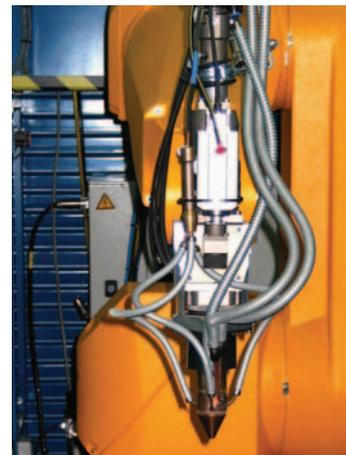
**Oben:** 6-Achsen Roboter mit montierter Optik, Kamera und koaxialer Pulverzufuhrdüse
