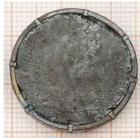
Schlackeprobe, mit einer Sonde aus der flüssigen Schlackeschicht gezogen
