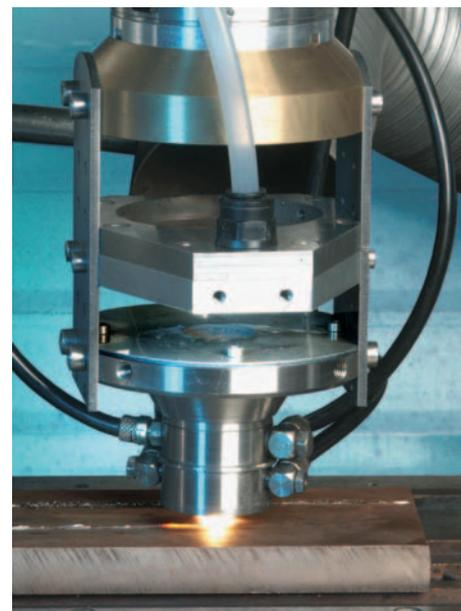
Schweißen von Baustahl mit der Radialjetdüse
