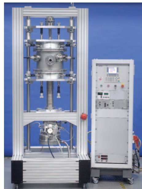
Oben: EUV-Transmissionsmikroskop mit Steuereinheit Unten: Mikroskopische Aufnahme eines 150 nm dicken Si-Filters mit Ni-Stützgitter und Artefakten
