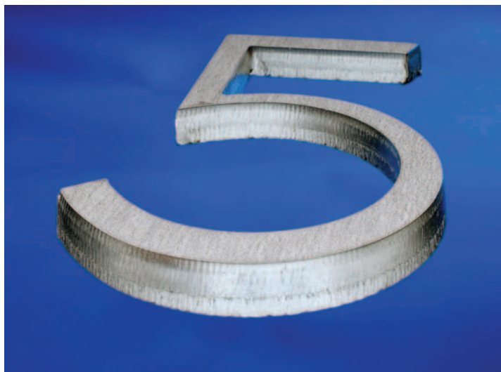
Oxydfreier Schnitt in Edelstahl, 10 mm Materialdicke
