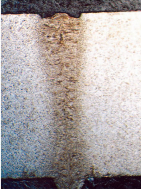
Erstes Ergebnis einer Blindnahtschweißung in 10 mm Baustahl bei 7,2 kW Laserleistung und einer Schweißgeschwindigkeit von v_s = 1,2 m/min
