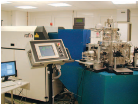
Prototyp der MOPA-Anordnung mit angeschlossener EUV-Plasma- Kammer (Foto: XTREME technologies)
