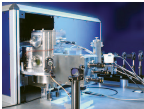
Laser, Spektrometer (eingehaust) und Messkammer für die Analyse kleinster Flüssigkeitströpfchen. Der Laserstrahl wird durch eine Strahlformungsoptik geführt und in die Kammer fokussiert. An der Kammer sind außen Instrumente zur Tröpfchenbeobachtung (CCD-Kamera, Lichtschranke) angebracht. Konstruktion und Aufbau der Kammer erfolgte durch den Projektpartner Forschungszentrum GKSS (Geesthacht).
