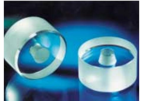
**Oben:** Ziehringe aus Saphir zum laserunterstützten Tiefziehen rotationssymmetrischer Nöpfe.
