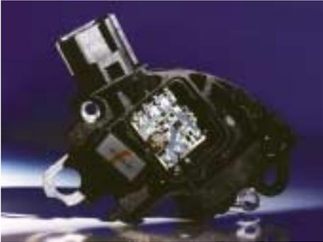
Keramischer Schaltungsträger mit lasergelöteten Anschlusskontakten.
