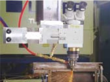
Diodenlaser-Schneiden von Edelstahlblech der Dicke 0,5 mm.
