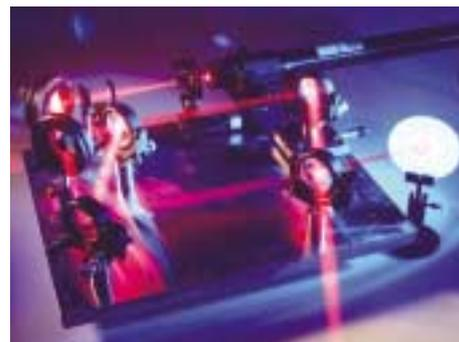
Mach-Zehnder Interferometer zur Untersuchung der Wechselwirkung von Laserpulsen mit nl-Tröpfchen.
