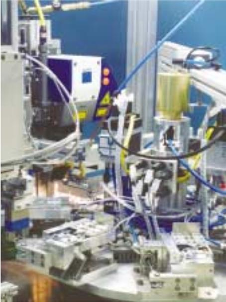
Laserstrahlbearbeitungsmaschine zur Entfernung des Mittelpols bei Halogenbrennern.
