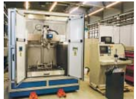
Anlage zum Laserstrahl- Auftragschweißen
