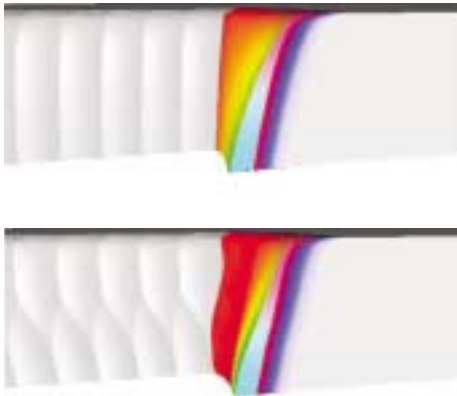
Oben: Riefen 1. Art Wärmediffusion Unten: Riefen 2. Art Diffusion und Konvektion
