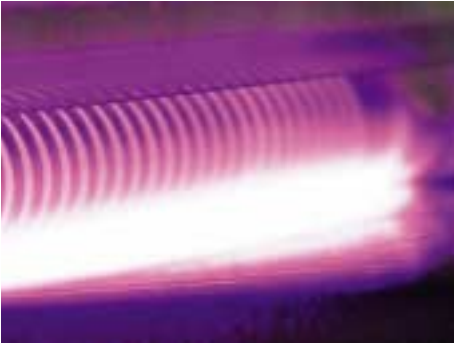
Atmosphärendruckplasma erzeugt durch eine Barrierenentladung
