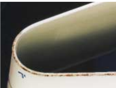
Beschichtete bzw. unbeschichtete Schnittfläche nach 1008 h Klima-Konstanttest
