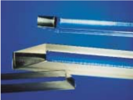
Oben: Ansicht der Schnittkanten Unten: Konturschnitte in verschiedenen Quarzglasrohren
