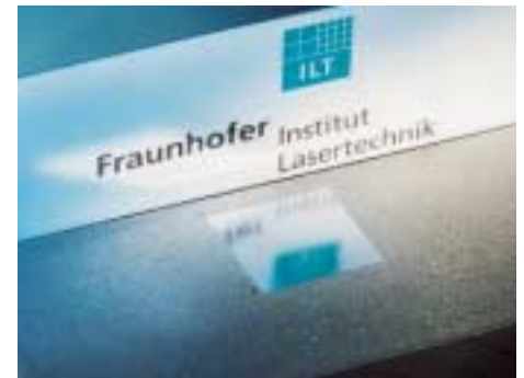
Oben: Erodierete Oberfläche selektiv poliert mit Laserstrahlung Unten: Laserstrahlpolierte 3D-Oberflächen
