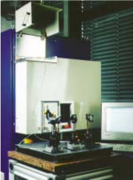
Ansicht des Analysesystems LISS für Metallproben: Messung mit Lichtleiterkopplung an einem externen Analyseaufbau
