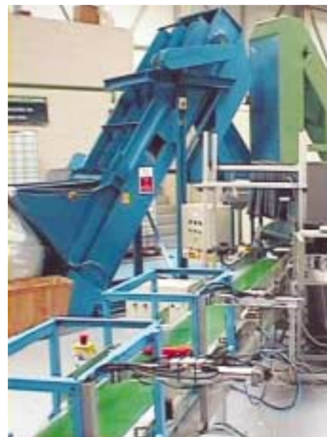
Oben: Pilot-Sortieranlage für technische Kunststoffe Unten: Schema des Autofokus-Systems für die Laser-Emissionsspektrometrie
