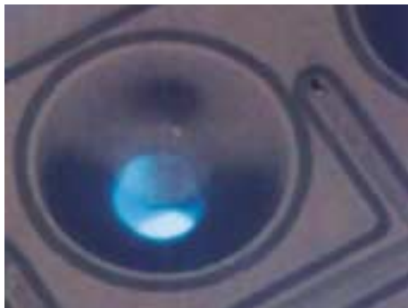
Mittels Kunststoffschweißen verschlossene Mikrofluidstruktur in PFA
