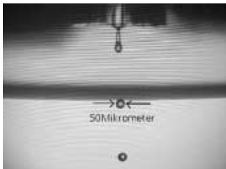
Stroboskopaufnahme kleiner Tröpfchen, Tröpfchenvolumen: ca. 65 pl
