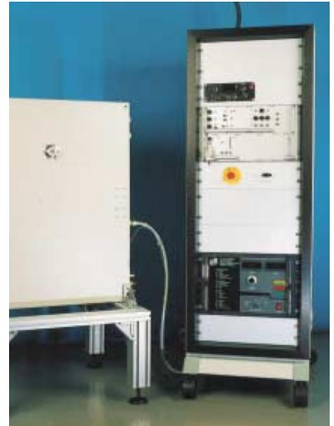
Gasentladungsquelle für EUV-Strahlung mit Steuereinheit. Bei einer elektrisch zugeführten Leistung von 2 kW werden ca. 10 W EUV Strahlung in einem Bereich von 10 nm - 16 nm Wellenlänge erzeugt.
