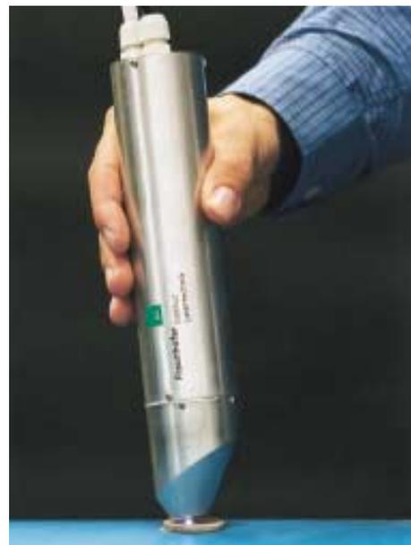
Handgeführter fasergekoppelter Messkopf. An der Spitze des Messkopfes ist das laserinduzierte Plasma einer gepressten Bodenprobe zu erkennen.
