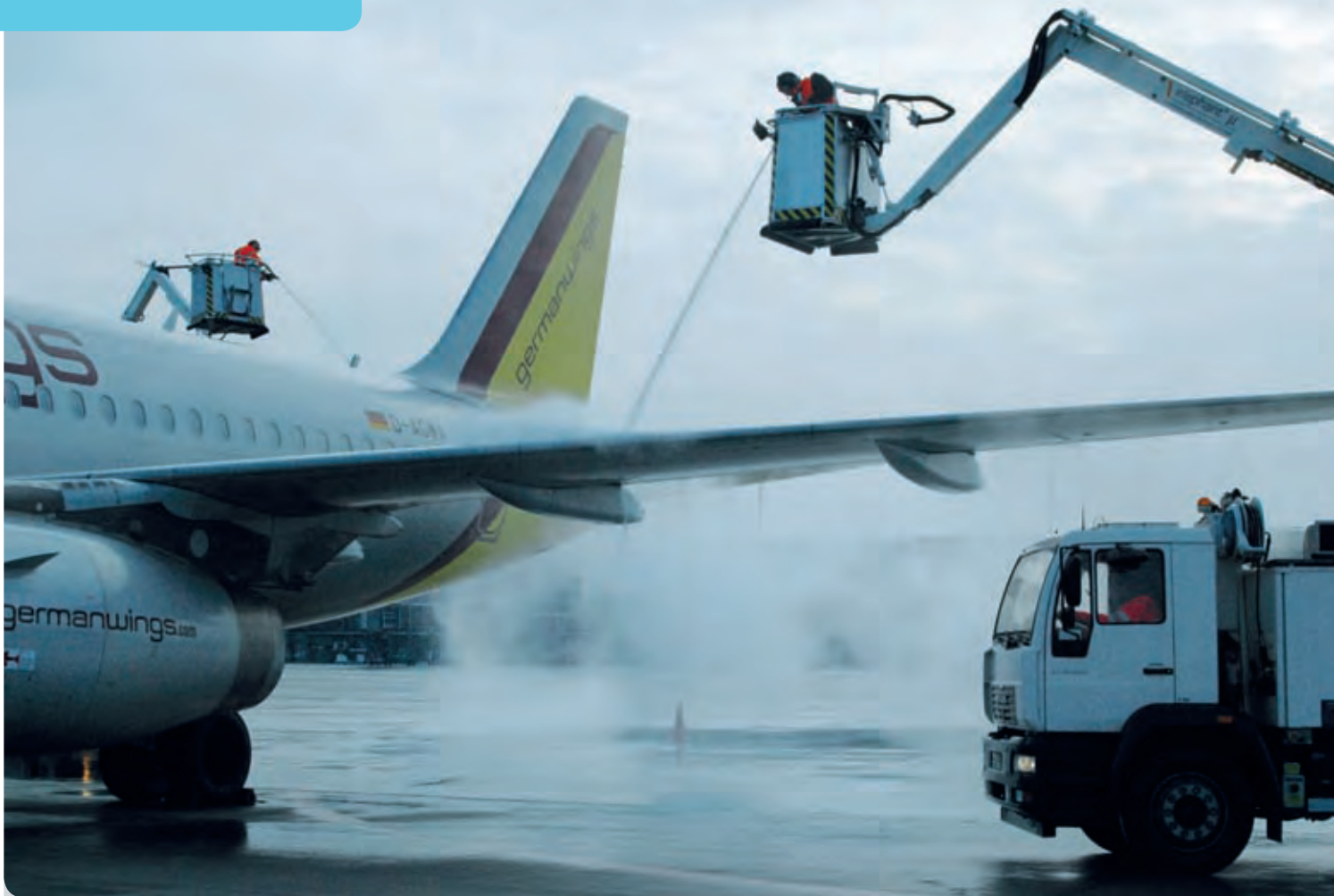
Bei der Flugzeug-Enteisung im Winter kommen nur biologisch abbaubare Enteisungsmittel zum Einsatz.
