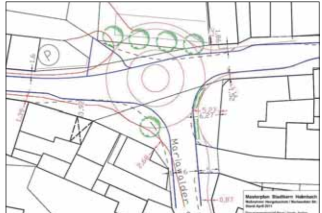
Vergleich Planung mit einem Minikreisel (rote Linien) und die Alternative mit einer T-Kreuzung und Bushaltestellen (blaue Linien).
