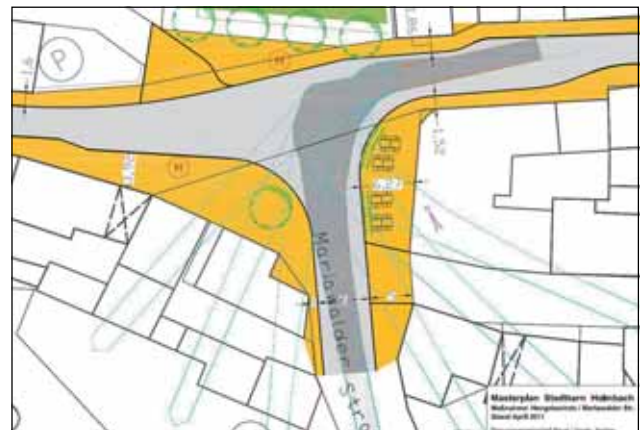
Die Planung berücksichtigt die Fahrkurve eines Sattelschleppers.
