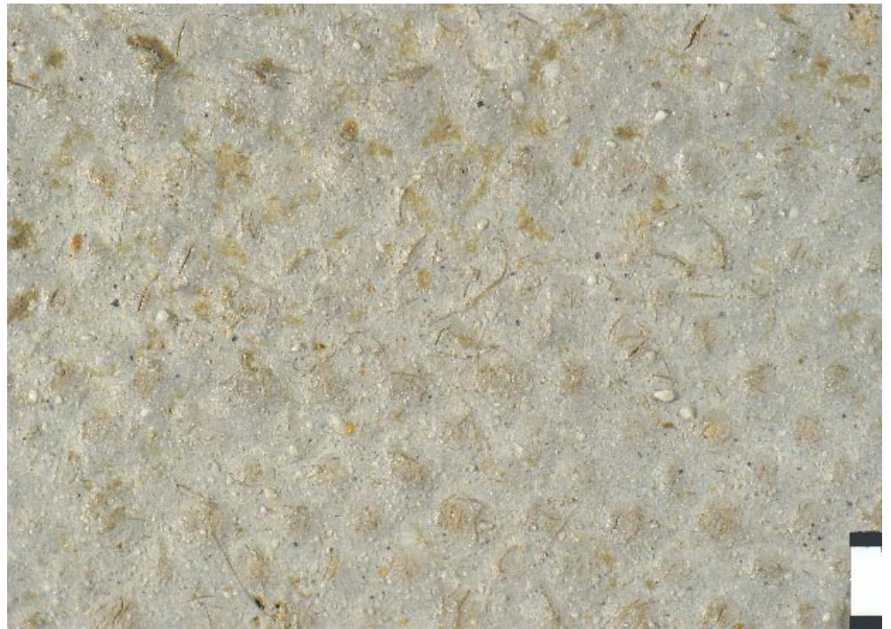
Abb. 5 Graue Grundierung, Mikroskopaufnahme (M = 1 mm)
