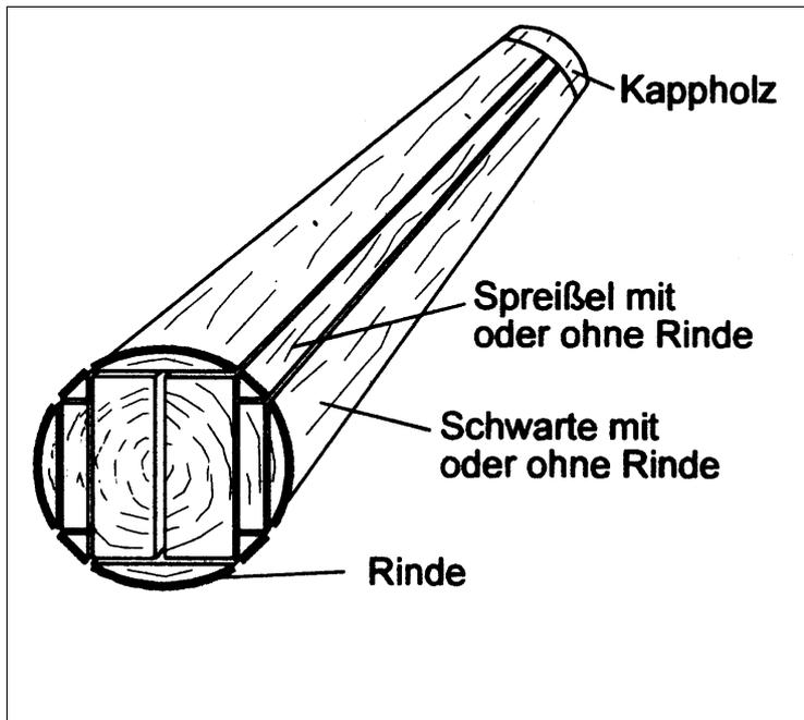
Abb. 8: Sägerestholzanfall bei der Holzbearbeitung (HARTMANN & MADECKER 1997)
