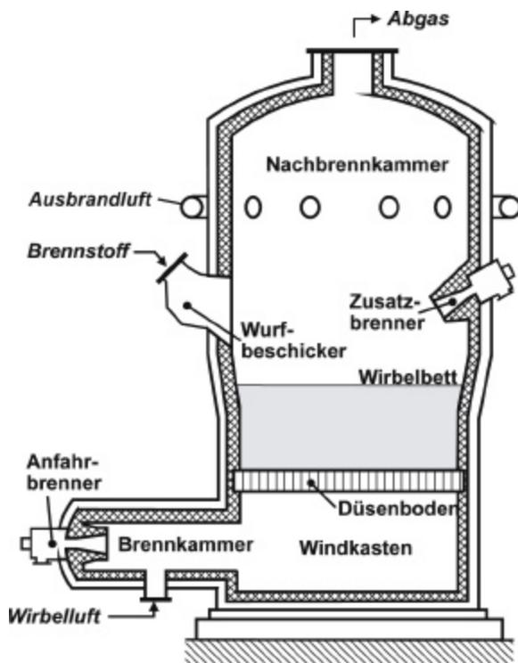
Abb. 12: Schematische Darstellung einer stationären Wirbelschicht (FNR 2000)
