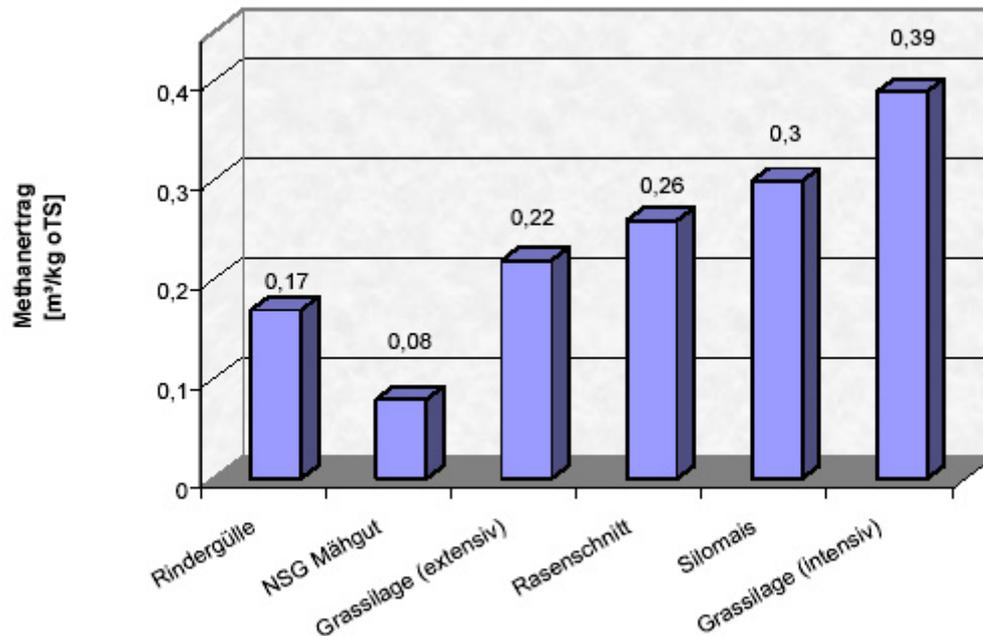
Abb. 19: Methanerträge siliertter Aufwüchse verschiedener Nutzungsformen, Labor-Durchflussversuche, mesophile Vergärung bei 25 Tagen Verweildauer (LEMMER & OECHSNER 2001).
