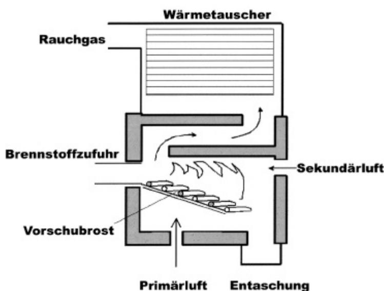
Abb. 10: Schematische Darstellung einer Vorschubrostfeuerung (FNR 2000)
