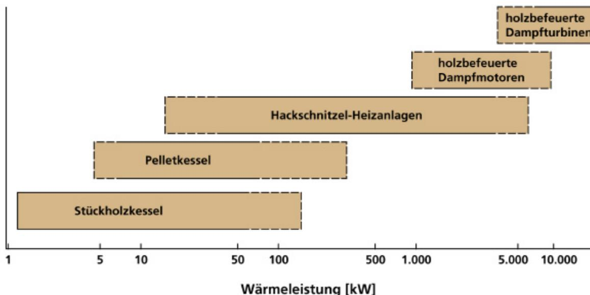
Abb. 16: Leistungsbereiche für unterschiedliche Aufbereitungsformen von Holzbrennstoffen (NIEDERSÄCHSISCHE ENERGIE-AGENTUR 2000)
