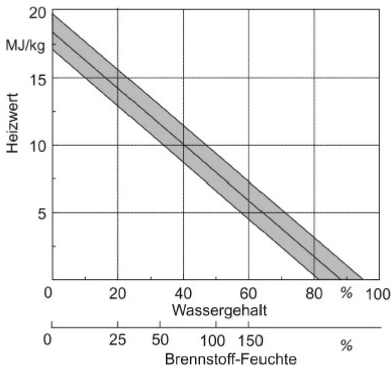
Abb. 17: Abhängigkeit zwischen Wassergehalt bzw. Brennstoff-Feuchte und Heizwert am Beispiel eines Holzbrennstoffs (FNR 2000)
