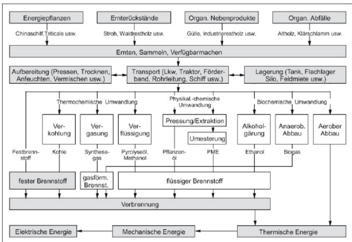
Abb. 1: Strom- und Wärmeerzeugung aus Biomasse (KALTSCHMITT & HARTMANN 2001: 3)
