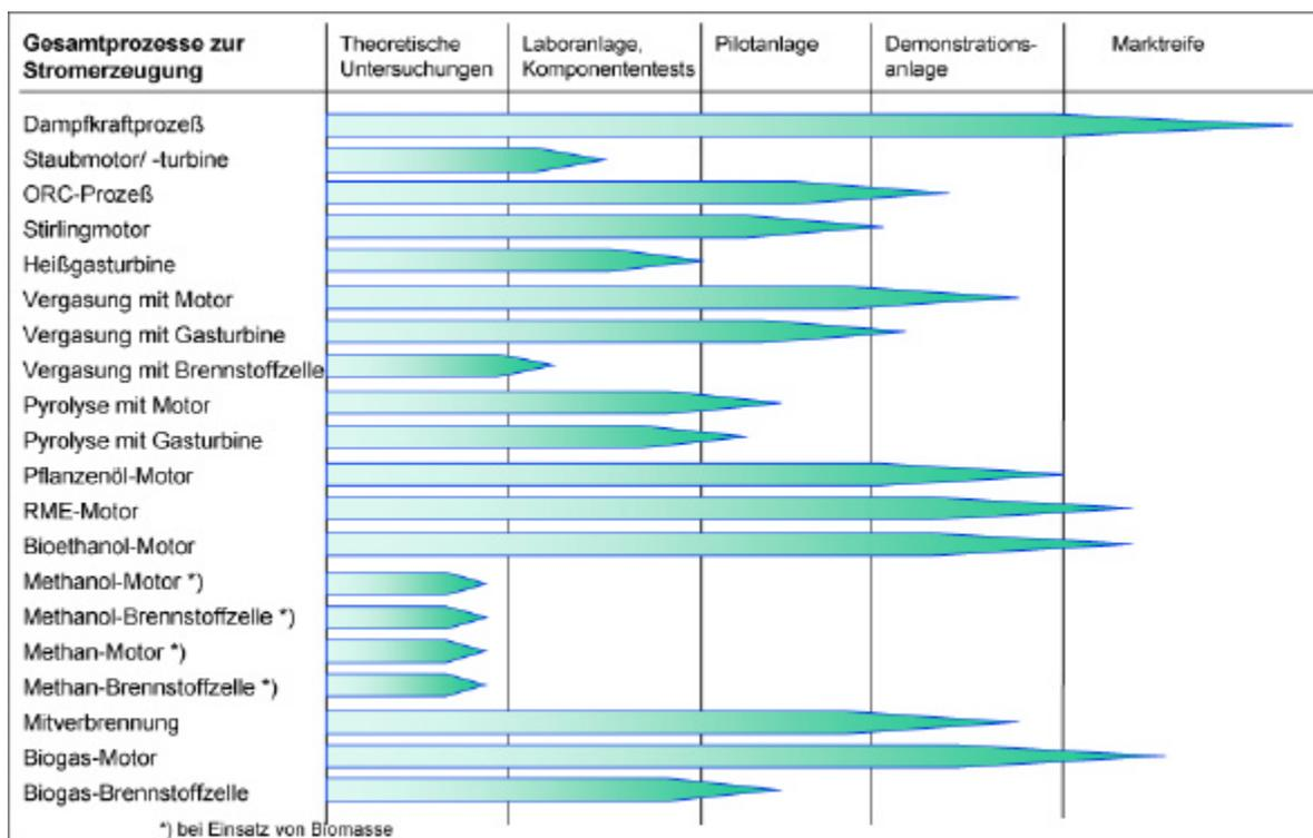
Abb. 4: Entwicklungsstand der Techniken zur Stromerzeugung (HEINRICH & JAHRAUS 2001)
