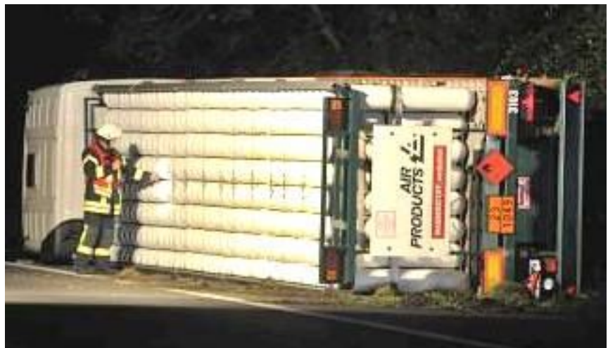
Umgekippt, aber dicht geblieben: ein prüfender Blick zwischen die Gasbehälter, die gefüllt bis zu 200 Bar Druck haben können.
