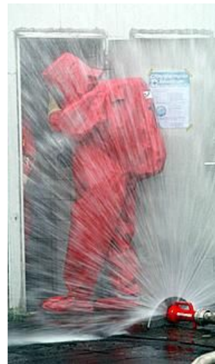
Die Anzüge sollen die Feuerwehrkräfte schützen. Vor dem Eingang des Bades errichtete die Feuerwehr einen so genannten Hydroschild – eine Art Wasserwand. Sie sorgt dafür, dass das Chlor eine Verbindung mit dem Wasser eingeht und so nicht mehr in die Atemluft gelangen kann.
