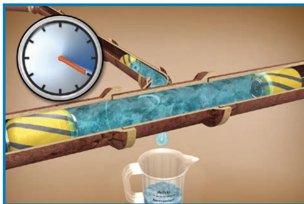
Druckprüfung mit Wasser
