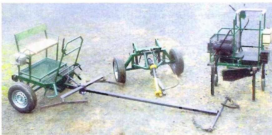
Abb. 5.21: Vorderwagensystem *Pintow Triple System*
