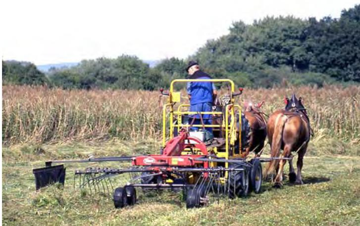
Abb. 5.30: Kreiselschwader an Vorderwagen
