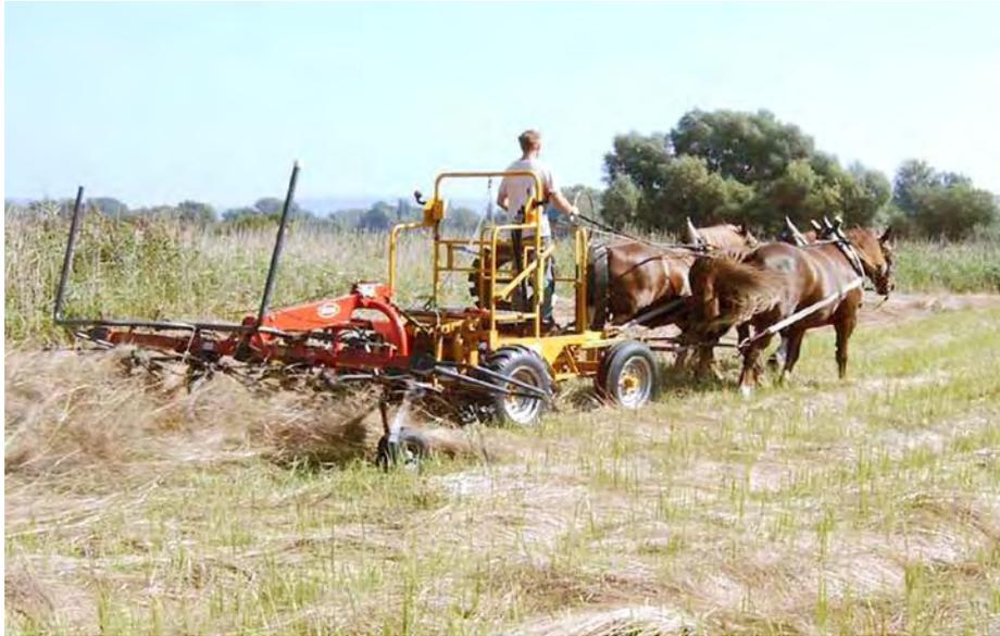
**Abb. 5.26: Kreiselheuer an Vorderwagen mit Boden getriebener Zapfwelle**
