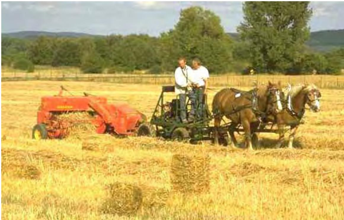
**Abb. 5.31: Ballenpresse an Vorderwagen mit Motor getriebener Zapfwelle**
