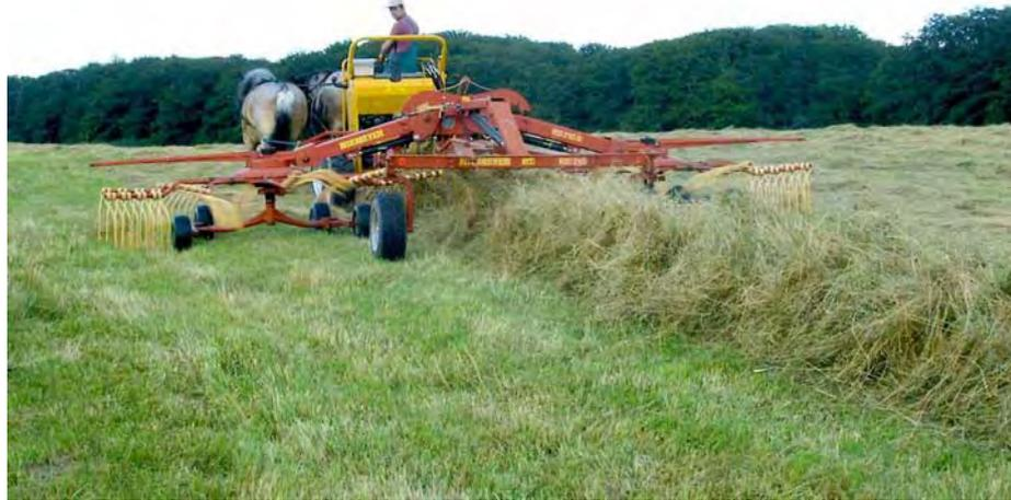
Abb. 4.2 Doppelkreiselschwader an Vorderwagen
