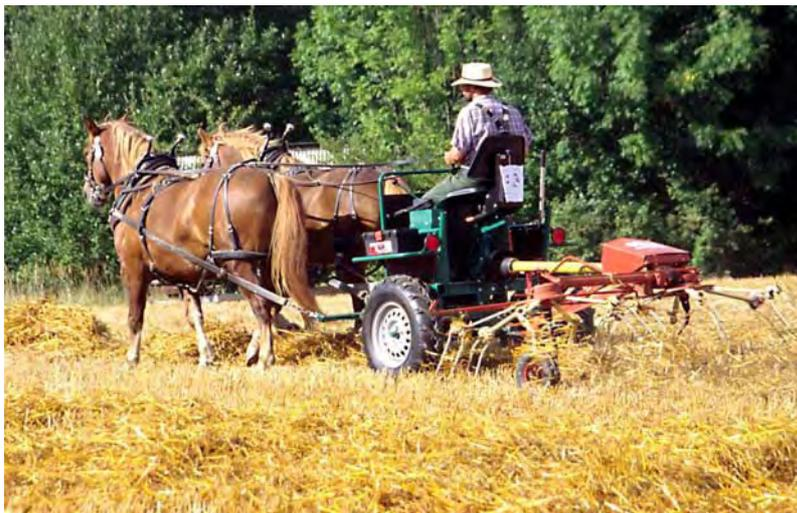
Abb. 5.9 Vorderwagen mit Boden getriebener Zapfwelle
