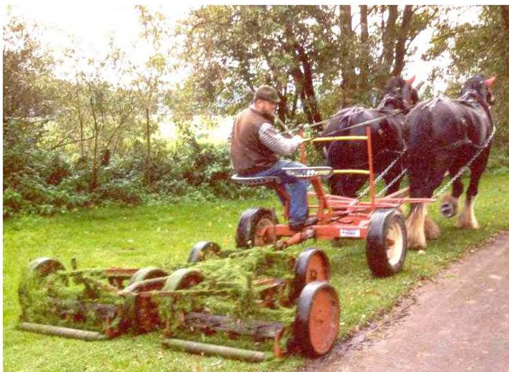
Abb. 5.44: Spindelmäher hinter Basisvorderwagen
