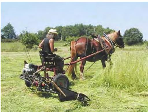
Abb. 4.1: Vorderwagen „Polynol“ mit angebautem Mähwerk
