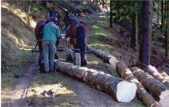
**Abb. 3.23: Transport von 5 m-Abschnitten mit Rückewagen**
