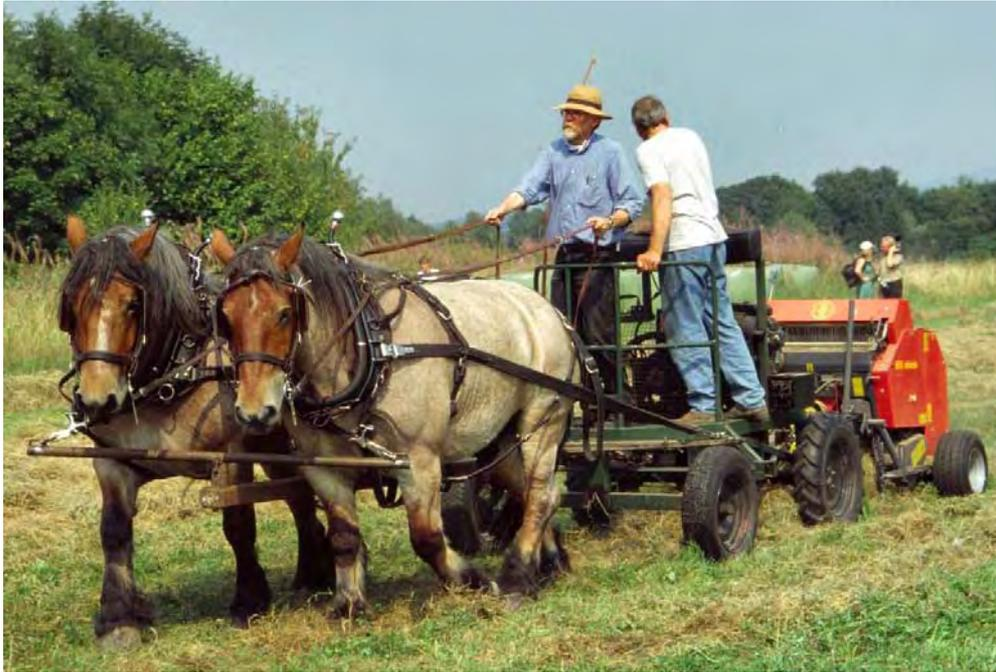
**Abb. 5.32: Mini-Rundballenpresse an Vorderwagen mit Motor getriebener Zapfwelle**
