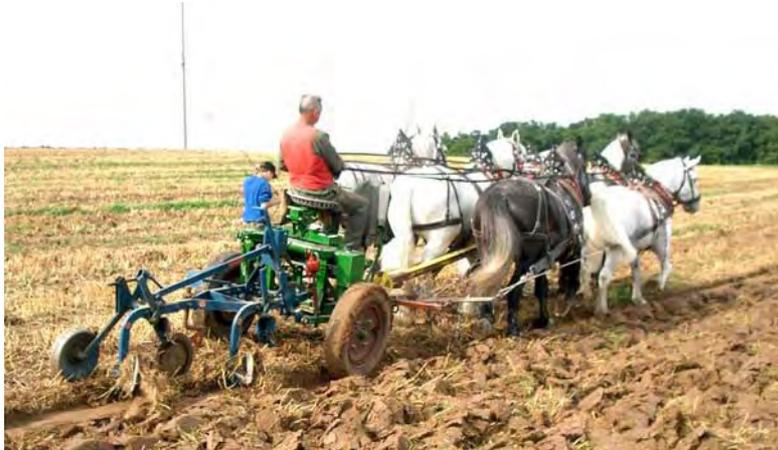
Abb. 5.8: 3-Punkt-Hydraulikvorderwagen mit 2-Schar-Pflug
