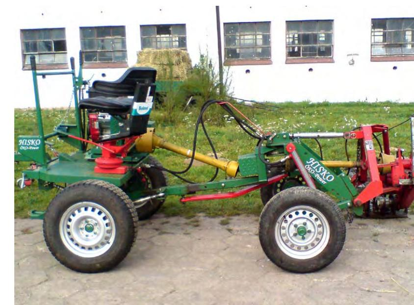
Abb. 5.19: Vorderwagen *HISKO* mit Motor getriebener Zapfwelle
