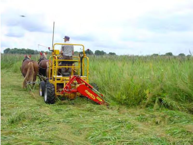
**Abb. 5.25: Doppelmessermähwerk von Mörtl an Vorderwagen Octoplus**
