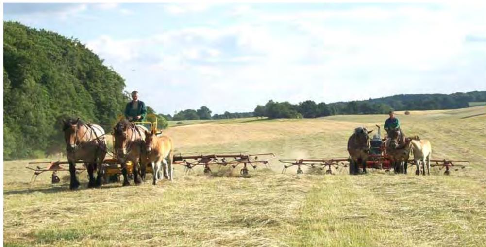
**Abb. 5.27: Kreiselheuer an Vorderwagen mit Motor getriebener Zapfwelle**
