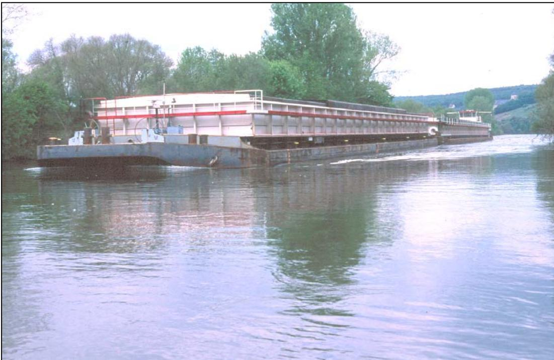
Abbildung 35: Bergfahrt eines Schubverbandes auf dem Main: Vor dem Schiff entsteht eine Bugwelle; entlang des Schiffes wird der Wasserkörper beschleunigt, der Wasserstand ist reduziert
