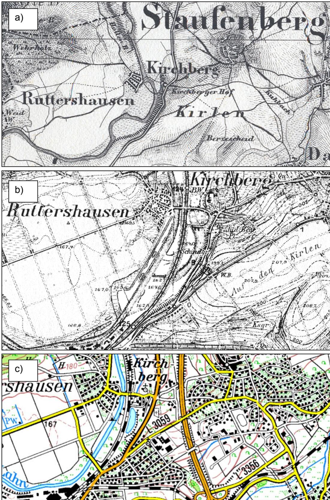
Abbildung 8: Entstehung eines Altwassers an der Lahn bei Staufenberg im Rahmen des Eisenbahnbaus: a) vor und b) nach dem Bau der Bahntrasse (um 1825 und 1907) sowie c) in der aktuellen topographischen Karte
