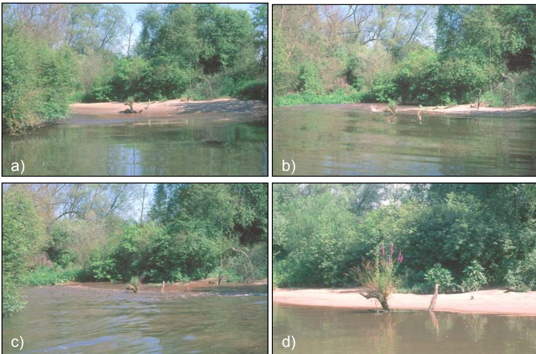
Abbildung 37: Ablauf des Brandungsgeschehens in einem Bühnenfeld des Main bei Vorüberfahrt eines Schiffes
