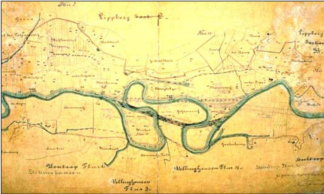
Abbildung 7: Variantendarstellung einer geplanten Flussbegradigung der Lippe bei Lippborg im 19. Jahrhundert
