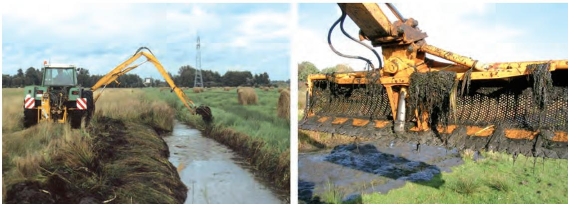
Abb. 4: Schonende Grabenräumung mit Mähkorb (l., Foto: NAGLER, A.); Mähkorb mit eingelegtem Lochblech (r., Foto: KLUGKIST, H.)
