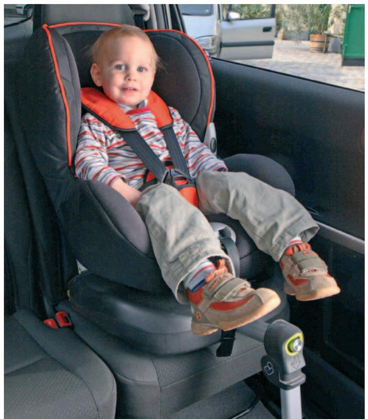
Fangkörper großflächig verteilt und die Belastung der Halswirbelsäule ist gering. Sitze mit Fangkörper können jedoch nicht in eine Schlafposition gestellt werden. Allerdings ist eine aufrechte Sitzposition auf jeden Fall sicherer als jede auch nur leichte Ruheposition.
