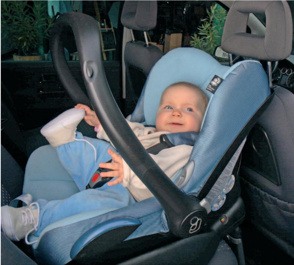
Werden Babys im Auto befördert, kommen nur rückwärts gerichtete Systeme der ECE-Gruppe 0+ in Frage (Babyschale), bei denen Babys in halbliegender Position entgegen der Fahrtrichtung gesichert werden. Der entscheidende Vorteil dabei ist, dass das Baby im Fall einer Kollision mit dem ganzen Körper in die Sitzschale gedrückt und sicher abgestützt wird.
