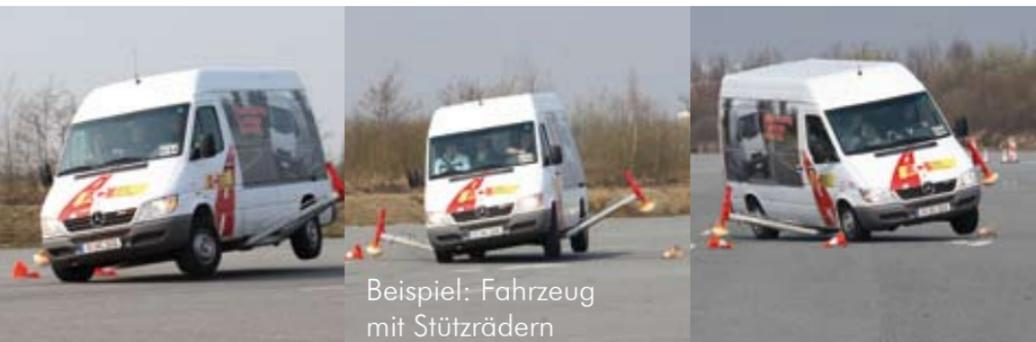
**Kippschutzsysteme** erkennen, wenn ein Fahrzeug – beispielsweise während eines Ausweichmanövers – zu kippen droht und begegnen der Gefahr durch automatisches Einbremsen aller Achsen. Ermöglicht wird dies durch komplexe sensorische Systeme, die alle zur Stabilität beitragenden Faktoren abfragen und auswerten.
