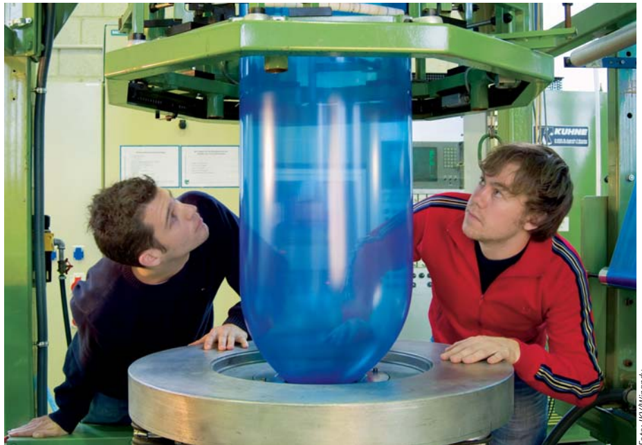
|| Jeder Studierende am IKV hat schon einmal eine komplexe Anlage bedient: hier die Blasfolienanlage im IKV-Extrusionstechnikum.
