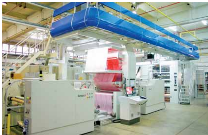
Die neue Acht-Farben-Druckmaschine bedruckt Folien mit bis zu 1.450 Millimeter Breite.
