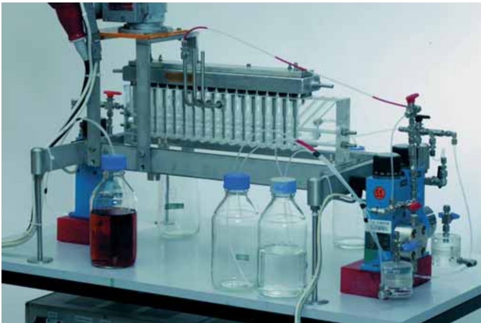
In solchen Apparaturen, in der Fachsprache Mixer-Settler genannt, laufen die Jülicher Experimente zur Trennung von Neptunium, Americium und Curium.
