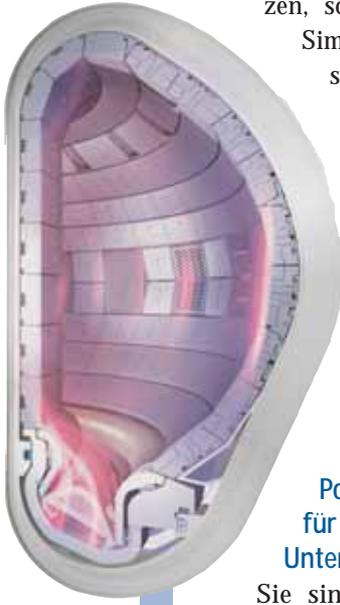
Querschnitt der Brennkammer mit animiertem Plasma. Das Forschungszentrum Jülich entwickelt die Wandmaterialien für das Fusionsexperiment ITER.
