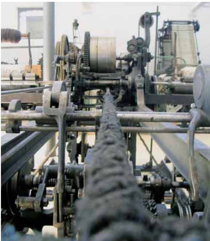
Dieser 1913 im Elsaß gefertigte Selfaktor ist eine Weiterentwicklung der Mule-Spinnmaschine.
