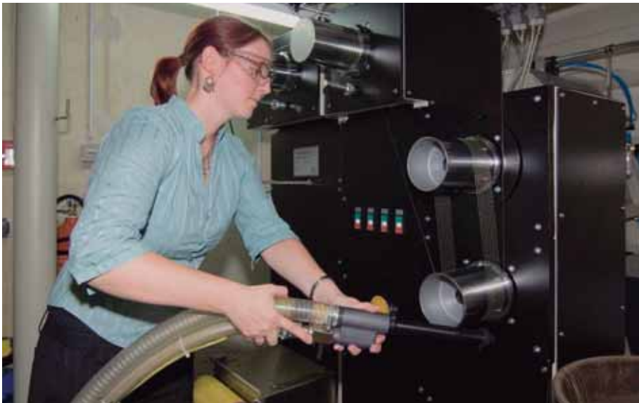
Im Bikomponenten-Spinn-turm des Instituts für Textiltechnik ITA der RWTH Aachen legt die wissenschaftliche Mitarbeiterin Dipl.-Ing. Stéphanie Houis den gesponnenen Faden auf die Galetten. Hier erfolgt das Aufwickeln der Fäden auf den Wickler und die Spulen.
