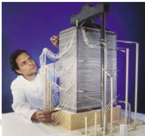
Mehrere hintereinander geschaltete Brennstoffzellen nennt man Stack.
