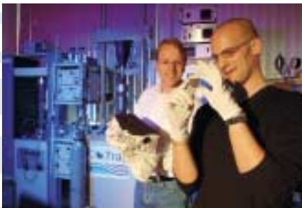
An der RWTH Aachen werden im Rahmen des Projektes Messungen an Gesteinen durchgeführt. Hier untersuchen Andreas Busch und Dr. Michael Kühn einen aus dem Kohleblock erbohrten Plug.
