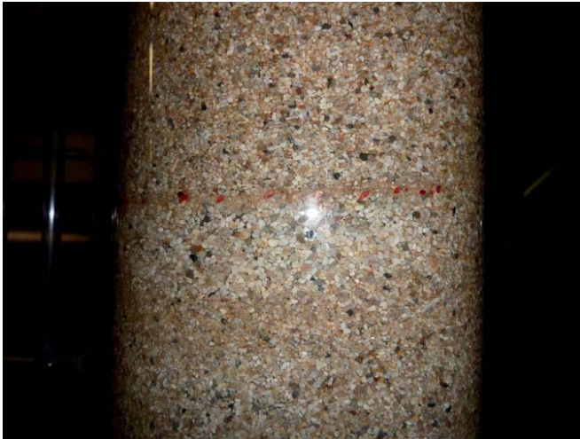
Bild 2.8: Bildung von Schüttungsbändern beim Füllvorgang
