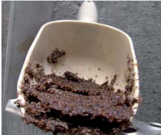
Bild 2.7: Kolmationsprodukte aus einem Kiesbohrloch [7]
