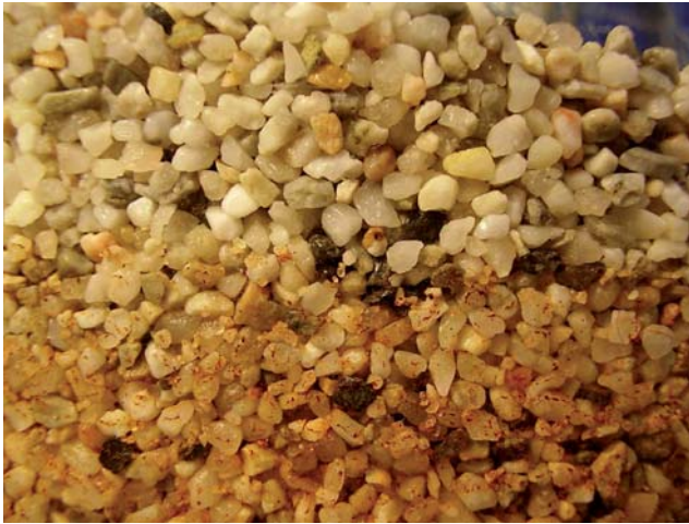
Bild 2.9: Ausspüleffekt an der Oberfläche des Gegenfilters (Suffusionsband)
