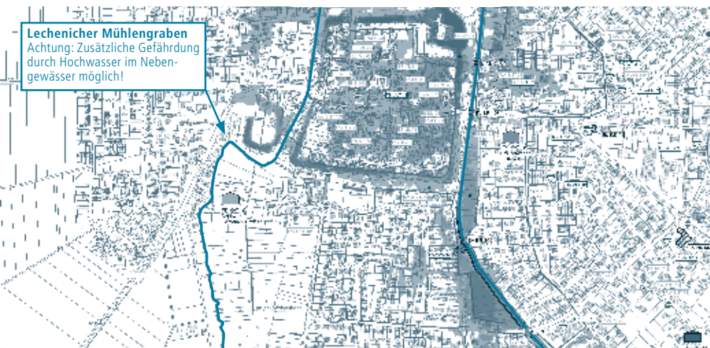
Hochwassergefahrenkarte Rotbach, Bereich Lechenich, Lastfall rot (dunkel eingefärbte Flächen)
