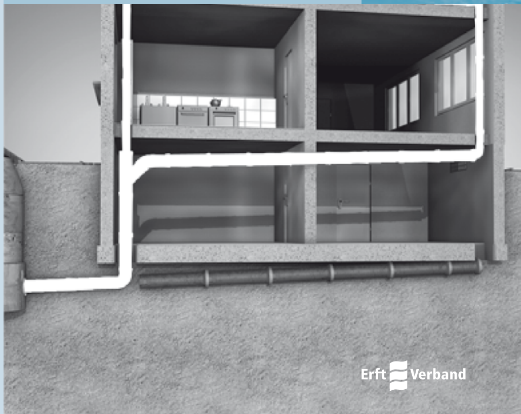
Sanierung von Grundleitungen durch abgehängte Installation (Bildnachweis: Visaplan)
