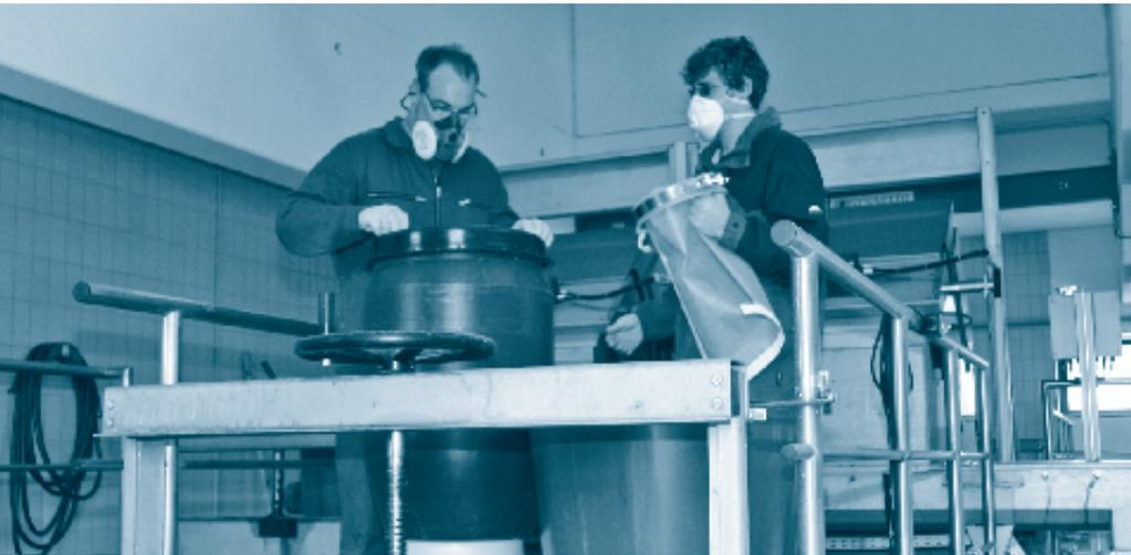
Probenahme aus der mechanischen Abwasserreinigungsstufe des Klärwerks Nordkanal
