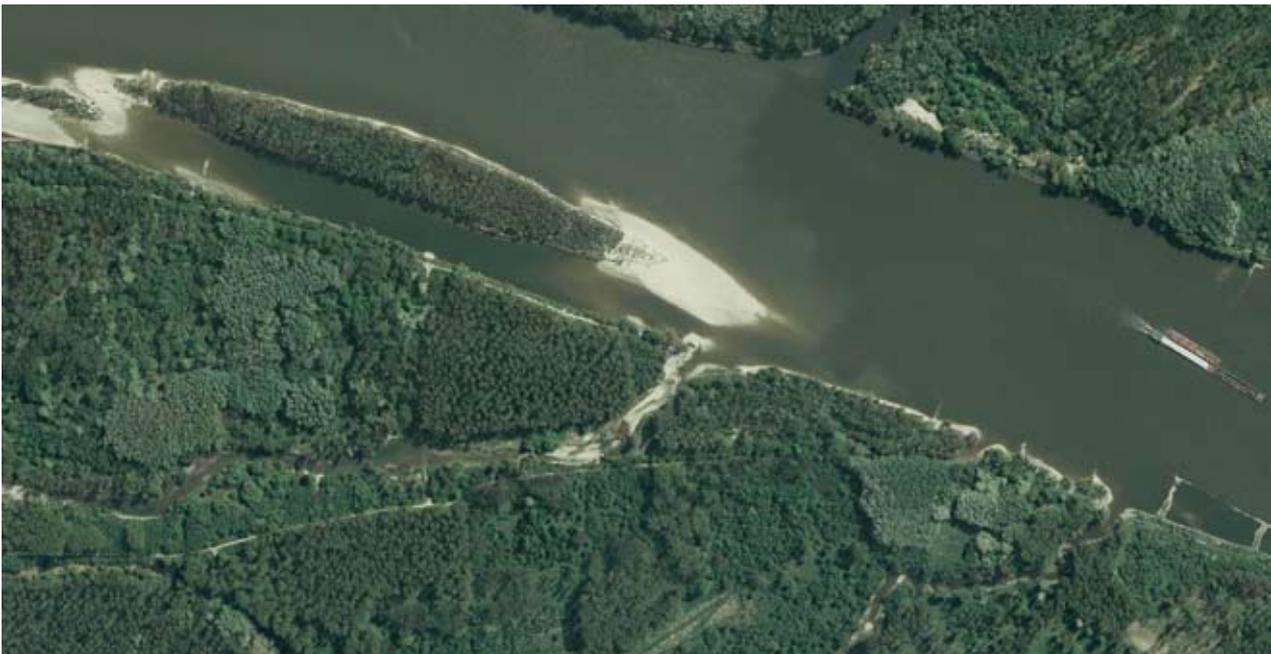
Nach Umsetzung der Gewässervernetzung sind 2003 bereits erste Erfolge sichtbar: Kiesflächen signalisieren die Rückkehr der Dynamik in das Seitenarmsystem, die Breite des Gewässerzuges hat wieder deutlich zugenommen.
