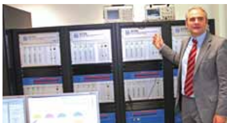
Am Institut von Professor Antonello Monto werden elektrische Übertragungs- und Verteilernetze in Echtzeit simuliert.
