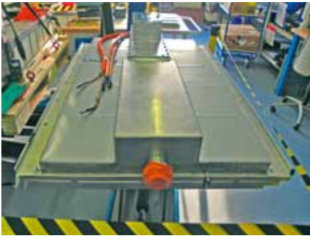
Zwölf Batteriemodule werden bei FEV in einem Metallkasten „versteckt“ und unter den Wagenboden des Fiat 500 montiert.
