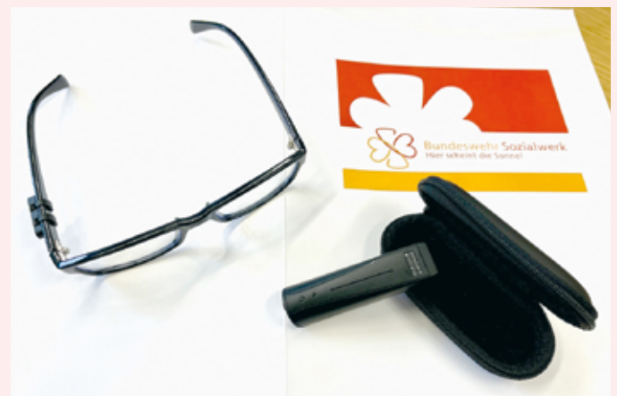
OrCam MyEye: Links im Bild die Brille mit Kamerahalterung, rechts die 22,5 g leichte und 76 mm lange Kamera mit Etui.
