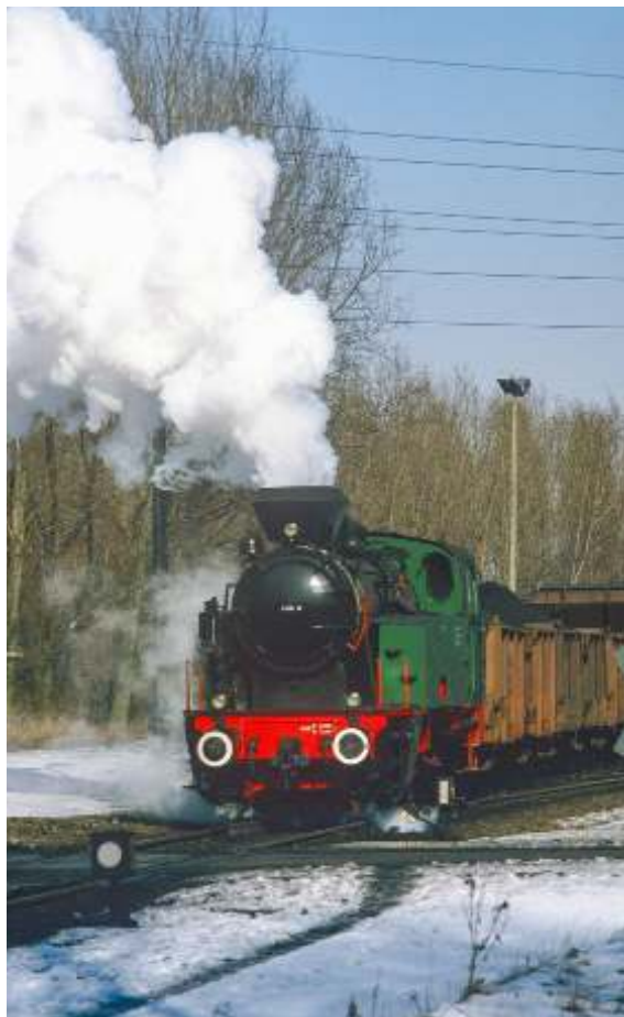
Bild 5: Auf der Grube Emil Mayrisch war die Lok Nr. 3 der Favorit der Eisenbahnfreunde, da sie mit einem Kobelschornstein ausgerüstet war. Am 13.2.1986 wurde sie von Pinguin Moschner bei schönstem Winterwetter abgelichtet
