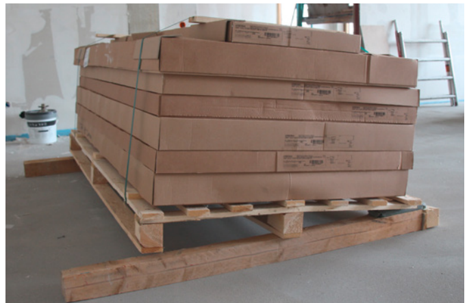
Abb. 6: Beschädigte und nicht unterfahrbare Einwegpalette; Quelle: Technische Universität Braunschweig, Institut für Bauwirtschaft und Baubetrieb
