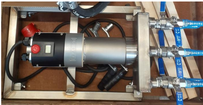
Abbildung 18: Heizaggregat des Typs LHS61L der Fa. Leister Technologies Deutschland GmbH (Wuppertal) mit montierter Ventilinsel.
