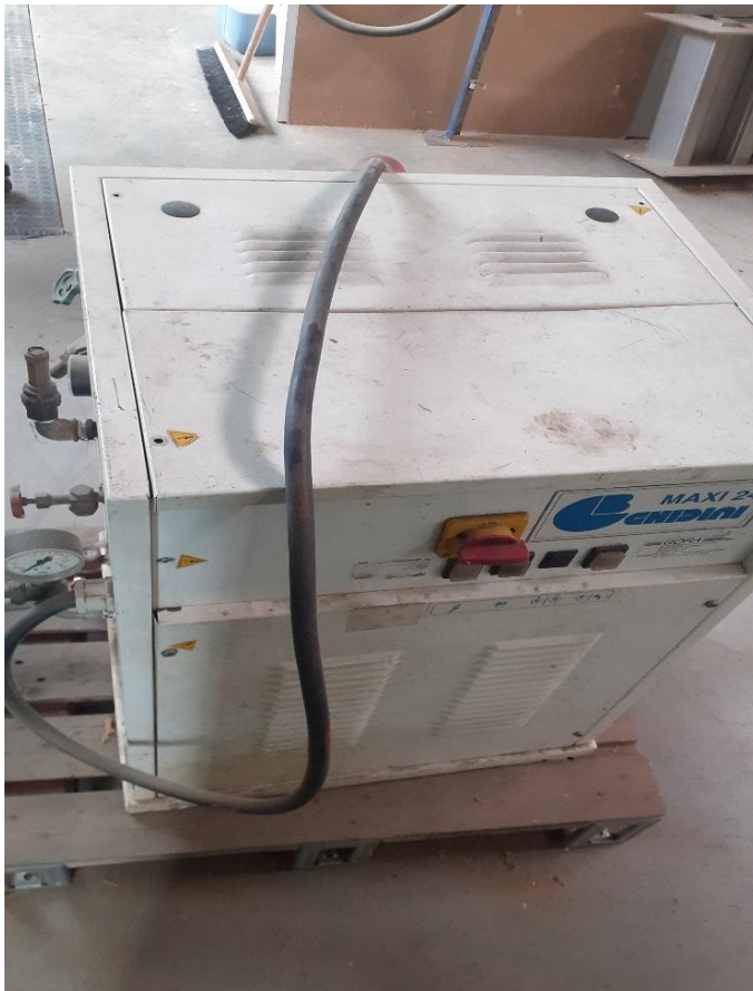
Abbildung 19: Dampferzeuger des Typs GHDINI Maxi 24; Ghidini Benvenuto Srl. (Giuliano Milanese; Italien)
