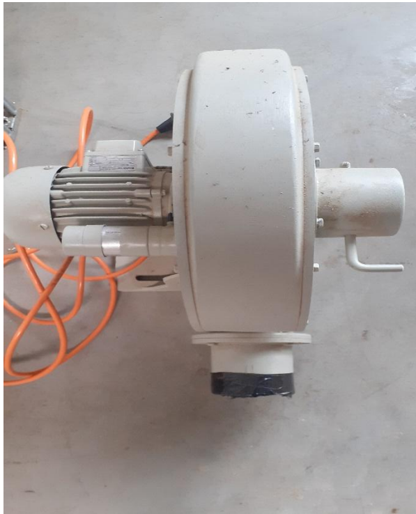
Abbildung 17: Radialverdichter mit 0,3 KW Antrieb und einem Volumenstrom von 12\text{ m}^3/\text{min} .
