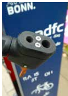
Häufigstes Verschleißobjekt: der Pumpenkopf
