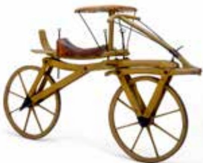
Draisine mit Ledersattel und Speichenrädern aus Holz
