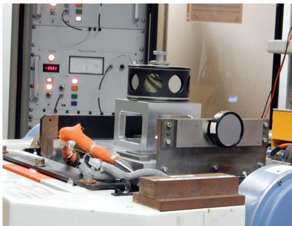
△ Abb. 2: Polygon- und planparalleler Spiegel zur Messung der Positionsgenauigkeit (Quelle: AIRBUS)
