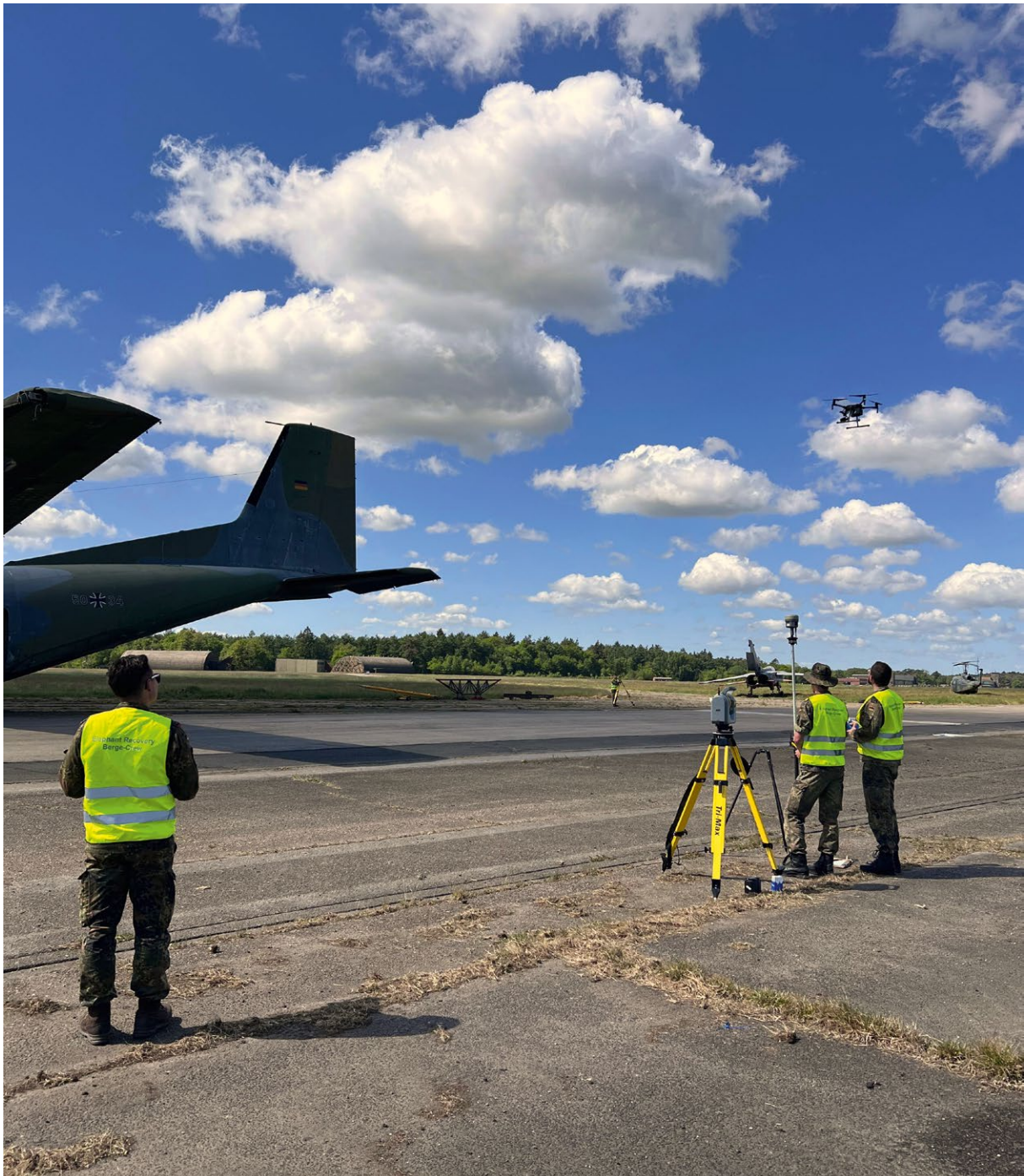
△ Abb. 3: Kombination aus stationärer und luftgestützter Vermessung (Quelle: ZGeoBw Dez BodgErf)
