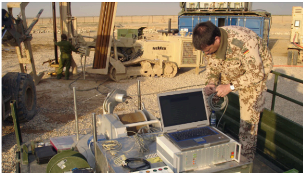
△ Abb. 5: Geophysikalische Vermessung einer Brunnenbohrung in Mazar-e-Sharif/AFG (Quelle: Bundeswehr/Hermel)
