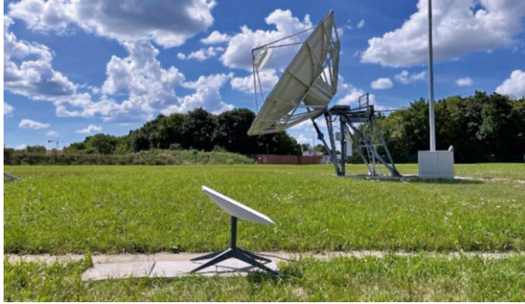
△ Abb. 3: Ein Starlink-Userterminal zur Signalmessung auf dem Antennenfeld der Universität der Bundeswehr München (Quelle: Bundeswehr/Hofmann)
