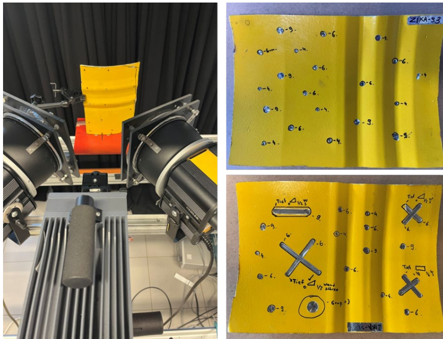
Abbildung 16: Angepasster Messaufbau mit zwei Halogenlampen und einer bolometrischen IR-Kamera (links); Zwei neue Fassausschnitte (Auswahl) als Probekörper zur Verfahrensqualifikation mit rückwärtig eingebrachten Defekten (rechts).
