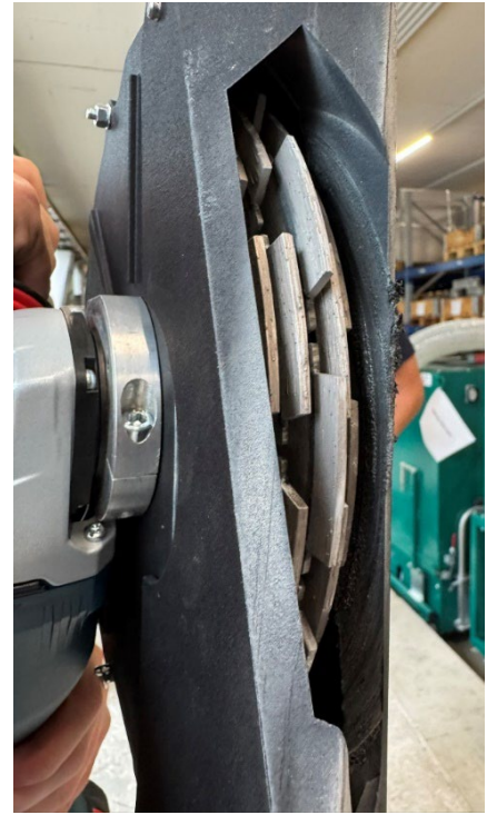
Abbildung 4: Kontakt der Frässcheiben mit Gehäuseaufsatz
