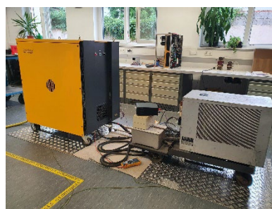
EMV Prüfung Invertermodul im Gehäuse
