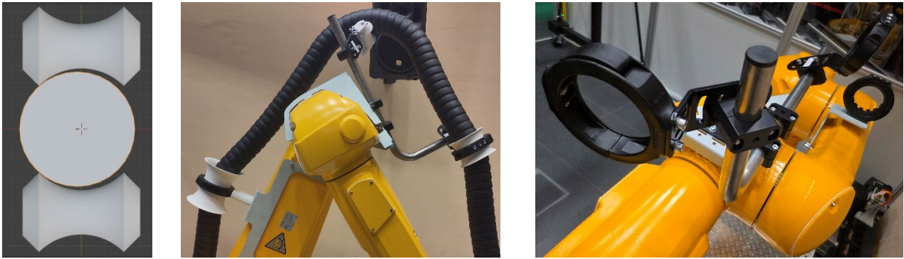
Fig. 1: Kabelführung entlang Roboterarm (links, Mitte: Eigenentwicklung, rechts: zu statische Variante des Herstellers IGUS).
