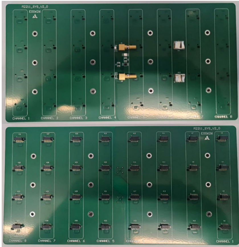
Abbildung 14. Entwickelte und Hergestellte Cross-Platine zum Anschließen von 32 Kanalleiterplatten
