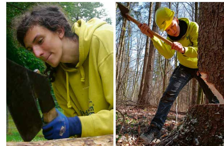
Zapfenstemmen, Richtfest, Holzbearbeitung mit dem Breitbeil, Fällung mit der Axt
