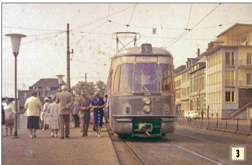
Der Doppeltriebwagen 430/431 stand als Linie S in der Endhaltestelle Siegburg. Das Foto entstand um 1960, als erste Modernisierungen am Fahrzeug vorgenommen wurden - hier sind die an die damals neuen Achtachser angeglichenen Blink- und Bremsleuchten erkennbar.
