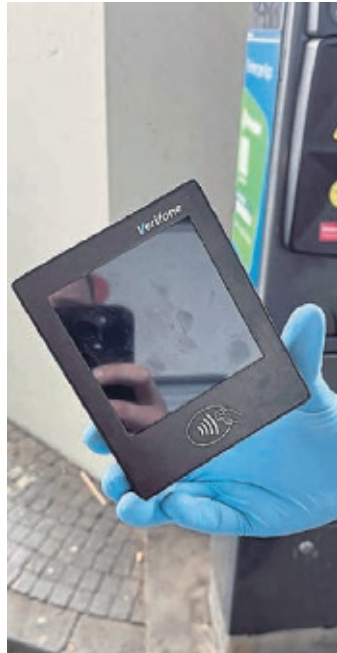
Ein manipuliertes Kartenlesegerät an einem Parkscheinautomaten. Foto: Polizei Köln
