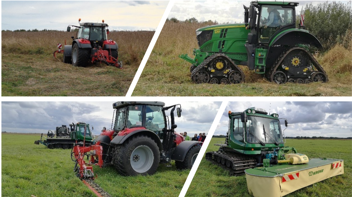
Abb. 16: Schlepper mit extra breiter Bereifung (Bild links oben), Schlepper mit bodenschonendem Gummiraupensystem (Bild rechts oben), Schlepper mit Breitreifen und Messerschneidwerk (Bild links unten), für Mahdarbeiten umgerüstete Pistenraupe (Bild rechts unten) (D. Mehl)
