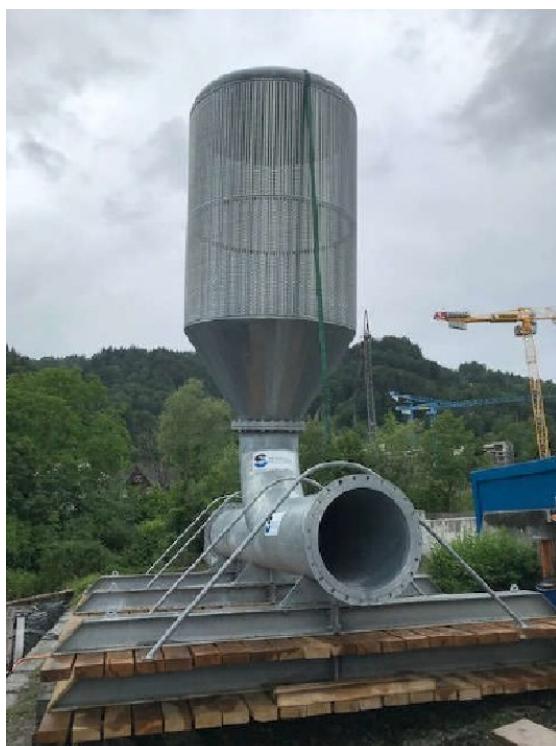
Abb. 5: In Horw (Schweiz) eingesetzter Seiher (Quelle: Energieinstitut Vorarlberg, 2024).
