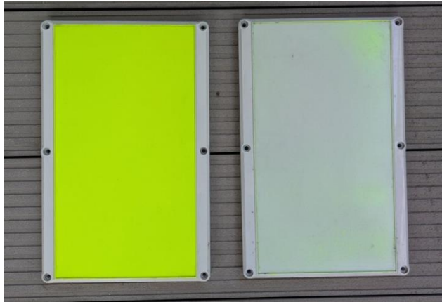
Abb. 120: Ausbleichen der gelben Lockfläche im Laufe der Erfassungssaison 2024. Links ist die Lockfläche zum Zeitpunkt der Installation zu sehen, rechts zum Ende der Erfassungssaison; Quelle: OekoFor.
