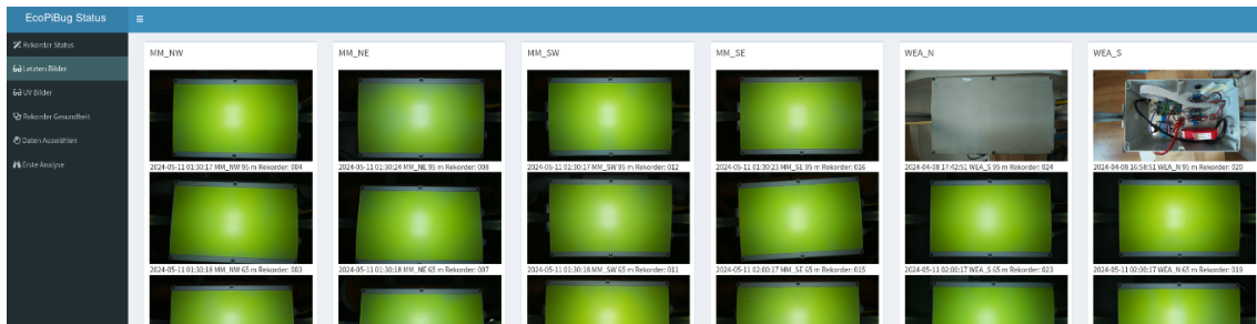
Abb. 128: Kontroll-App „Letzte Bilder“. Hier werden für jede Insektenfotofalle die letzten Aufnahmen in Form einer Bilder-Galerie dargestellt. Auffälligkeiten bzgl. der Gerätekamera sind hier schnell feststellbar.
