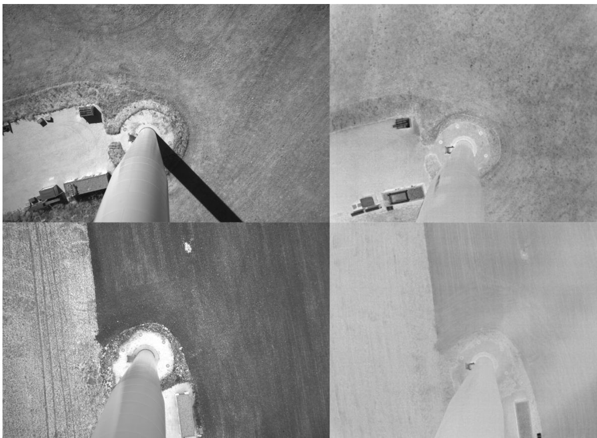
Abb. 108: Sichtfenster der Schlagopferkameras: Tageslicht-Kamera (links), Wärmebildkamera (rechts), WEA Nord (oben), WEA Süd (unten)
