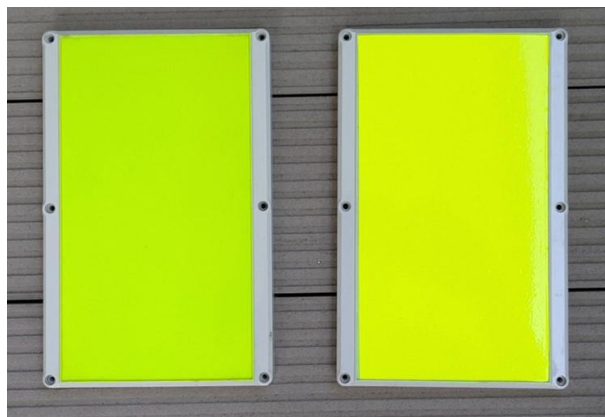
Abb. 121: Lockfläche 2024 und 2025 im Vergleich. Links ist die mit Acrylharzlack besprayte Lockfläche zu sehen. Rechts wurde die Lockfläche mit reflektierender Fluorfolie beklebt. Die beiden Gelbtöne weichen nur geringfügig voneinander ab; Quelle: OekoFor.
