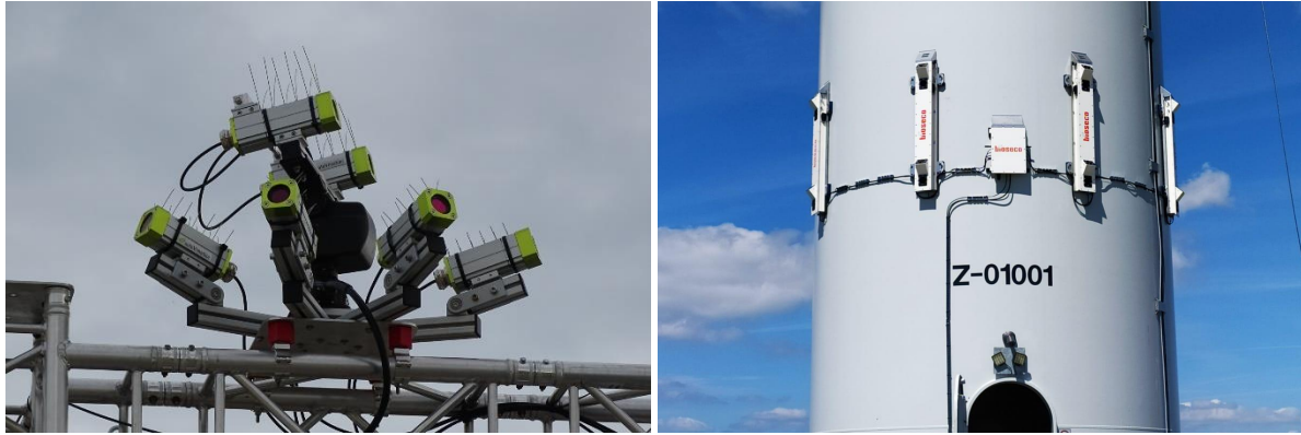
Abb. 35: Vogeldetektionssystem BirdRecorder (links; Quelle: J. Aschwanden) und BPS Long-Range von Bioseco; Quelle: Bioseco.
