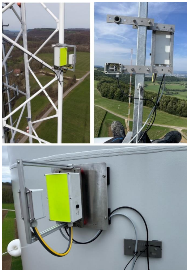
Abb. 124: Installierte Insektenfotofallen im Windtestfeld. Oben links: Insektenfotofalle am Messmasten (Drohnenaufnahme von M. Wigger, ZSW). Oben rechts: Insektenfotofalle auf der Gondel der FWEA. Unten: Insektenfotofalle am Turm der FWEA. Für die Installation am Turm ist die Fotofalle mit Isolierstützer auf einer Edelstahlplatte verschraubt, die mittels Starkmagneten an der Turmoberfläche befestigt wurde; Quellen: M. Wigger, ZSW; T. Aulehla, ZSW (oben rechts).
