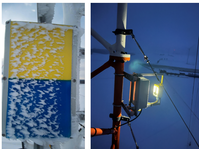
Abb. 123: Insektenfotofallen im Windtestfeld während der Wintermonate 2023. Trotz Schnee und Eis blieben die Insektenfotofallen funktionstüchtig; Quelle (Bild rechts): M. Wigger, ZSW).
